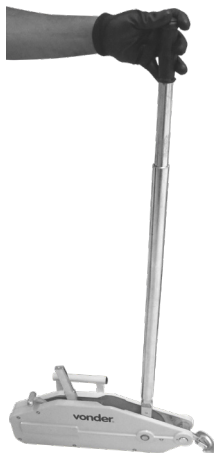
Figura 3 – Alavanca A - Tracionando ou puxando o cabo de aço
